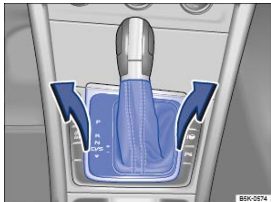
Fig. 221 Dépose du cache de la grille de guidage.
