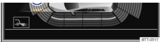
Fig. 152 Affichage à l'écran du système d'aide au stationnement (ParkPilot) : indicateur de trajet sans braquage.
