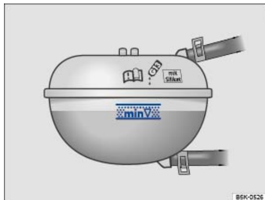
Fig. 201 Dans le compartiment-moteur : repères sur le vase d'expansion du liquide de refroidissement
