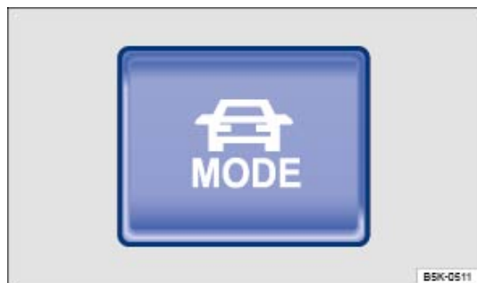
Fig. 184 Dans la partie inférieure de la console centrale : touche de sélection du profil de conduite.
