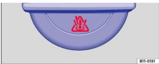
Fig. 202 Dans le compartiment-moteur : bouchon du vase d'expansion du liquide de refroidissement.
