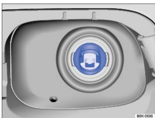
Fig. 195 Trappe à carburant ouverte : détrompeur de ravitaillement dans la goulotte de remplissage de carburant.
