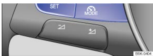
Fig. 167 Côté gauche du volant multifonction : touches de commande du limiteur de vitesse.
