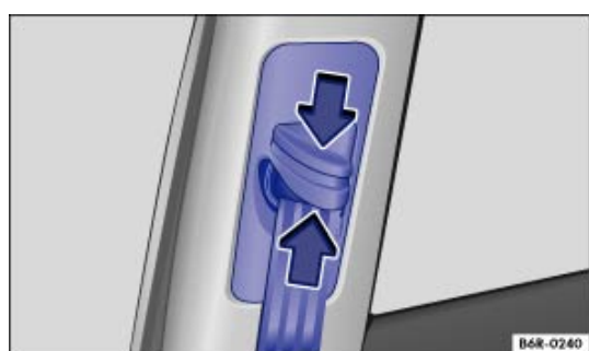
Fig. 69 À côté des sièges avant : réglage en hauteur de la ceinture.
