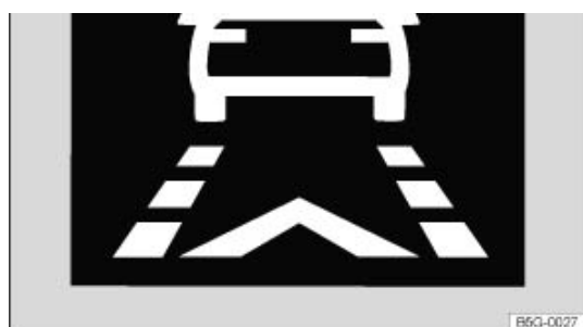
Fig. 176 Afficheur du combiné d'instruments : avertissement préalable
