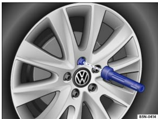
Fig. 236 Changement d'une roue : dévissage des boulons de roue à l'aide du manche de tournevis
