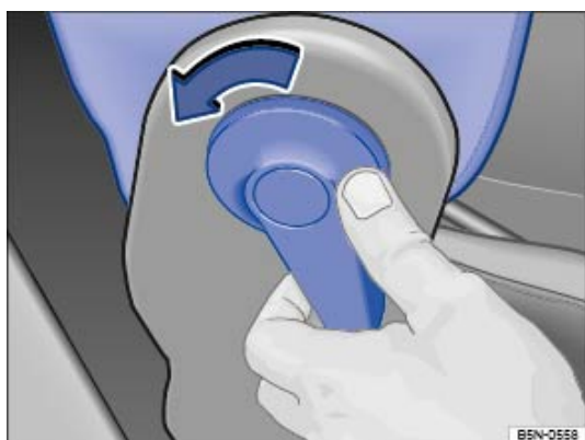
Fig. 57 Déverrouillage du dossier de siège escamotable du passager avant.
