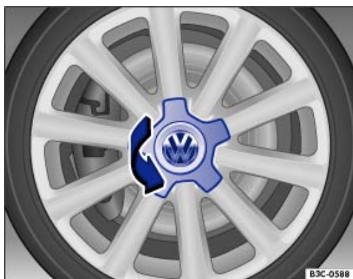
Fig. 226 Retrait de l'enjoliveur central par un mouvement de rotation
