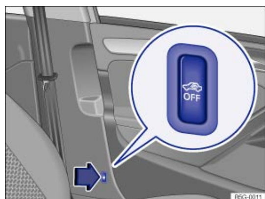
Fig. 32 À côté du siège du conducteur : touche de désactivation de la protection volumétrique et de la protection anti-soulèvement.
