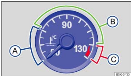
Fig. 200 Indicateur de température de liquide de refroidissement dans le combiné d'instrument : A Zone froide; B Zone normale; C Zone d'alerte.
