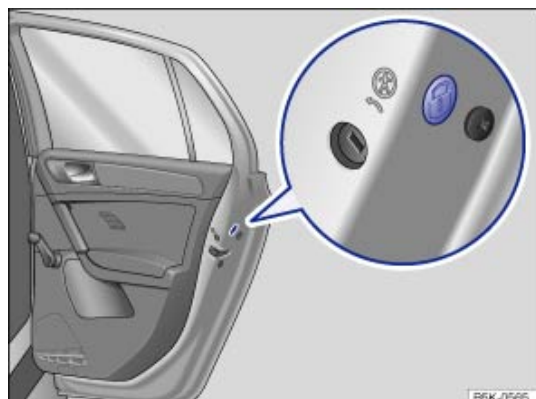
Fig. 217 Sur le chant de la porte arrière droite : verrouillage d'urgence masqué par un joint en caoutchouc.
