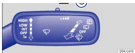
Fig. 89 À droite sur la colonne de direction : commande de l'essuie-glace arrière
