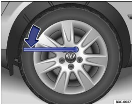
Fig. 229 Changement d'une roue : desserrage des boulons de roue
