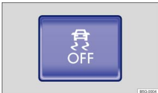
Fig. 143 Dans la partie inférieure de la console centrale : touche d'activation/désactivation manuelle de l'ASR, de l'ASR avec ESC ou de l'ESC Sport
