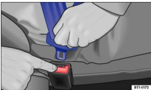
Fig. 66 Retrait du pêne du boîtier de verrouillage.
