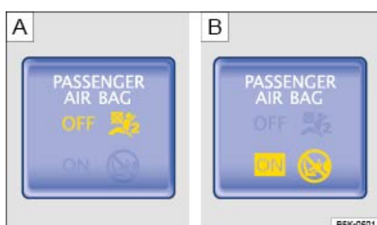
Fig. 70 Dans la partie supérieure de la console centrale : témoin de désactivation du sac gonflable frontal du passager avant (variante A) ou d'activation du sac gonflable frontal du passager avant
