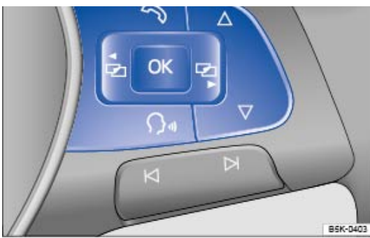
Fig. 17 Côté droit du volant multifonction : touches de commande des menus et des informations sur le combiné d'instruments.
