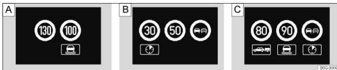
Fig. 182 Sur l'afficheur du combiné d'instruments : exemples de panneaux de limitation de vitesse et d'interdiction de dépasser détectés avec les panneaux supplémentaires correspondants.
