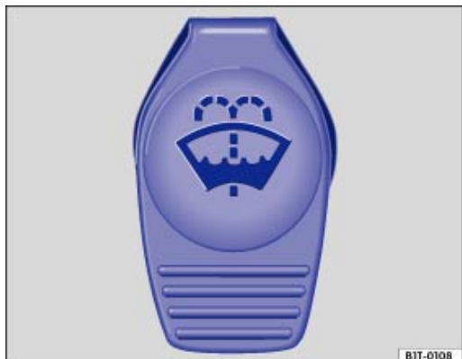
Fig. 93 Dans le compartiment-moteur : bouchon du réservoir de liquide de lave-glace.
