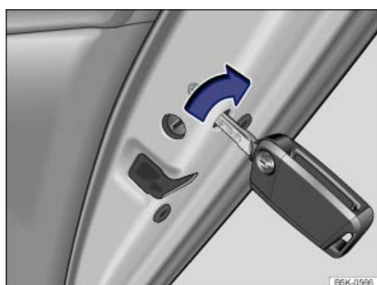
Fig. 218 Sur le chant de la porte arrière droite : verrouillage d'urgence du véhicule à l'aide de la clé du véhicule
