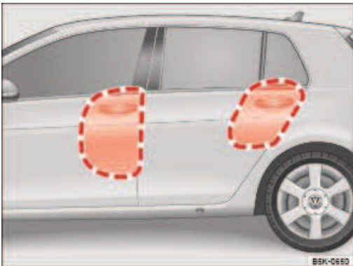
Fig. 45 Côté gauche du véhicule : zones de déploiement des sacs gonflables latéraux
