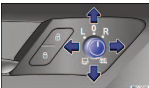
Fig. 100 Dans la porte du conducteur : bouton rotatif pour les rétroviseurs extérieurs
