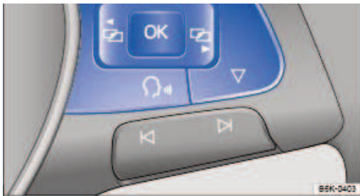
Fig. 23 Côté droit du volant multifonction : touches de commande des menus et des informations sur le combiné d'instruments
