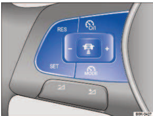
Fig. 130 Côté gauche du volant multifonction : touches de commande du régulateur de distance
