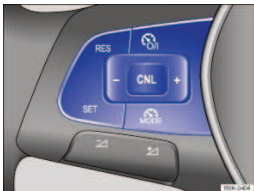
Fig. 126 Côté gauche du volant multifonction : touches de commande du limiteur de vitesse
