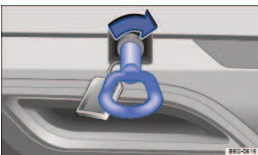
Fig. 200 Dans le pare-chocs arrière, côté droit : vissage de l'œillet de remorquage
