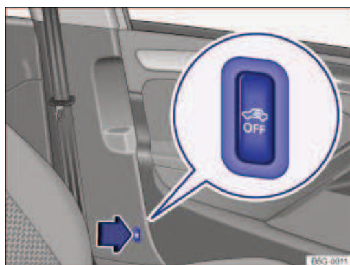
Fig. 67 À côté du siège du conducteur : touche de désactivation de la protection volumétrique et de la protection anti-soulèvement (selon l'équipement du véhicule).
