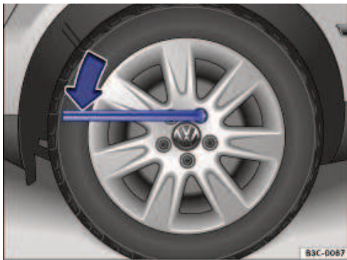
Fig. 224 Changement d'une roue : desserrage des boulons de roue
