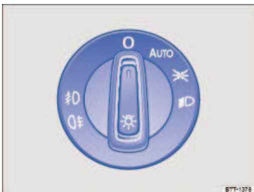
Fig. 89 À côté du volant : commande d'éclairage (une variante)
