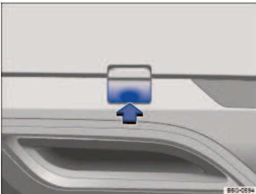
Fig. 199 Dans le pare-chocs arrière, côté droit : dépose du cache
