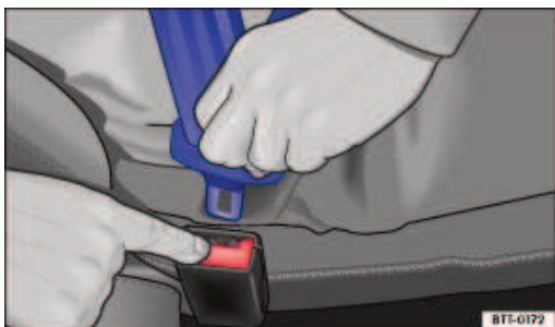
Fig. 37 Retrait du pêne du boîtier de verrouillage
