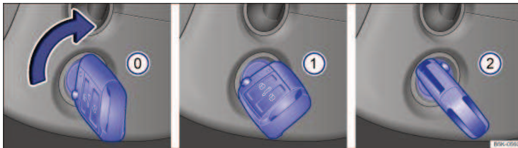
Fig. 110 À droite du volant de position : positions de la clé du véhicule dans le contact-démarrreur
