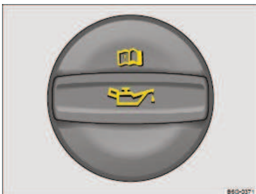
Fig. 208 Dans le compartiment-moteur : bouchon de l'orifice de remplissage d'huile-moteur (schéma de principe)
