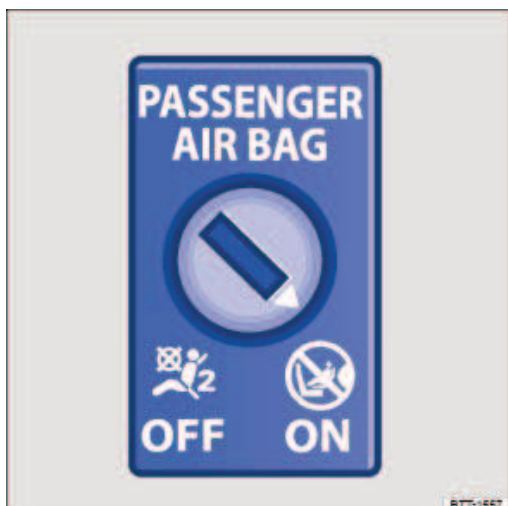
Fig. 44 Dans le tableau de bord côté passager avant : commande à clé de désactivation et d'activation du sac gonflable frontal du passager avant
