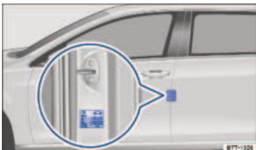
Fig. 216 Sur le montant de la porte du conducteur : plaquette de pression de gonflage des pneus (ou sur la face intérieure de la trappe à carburant)
