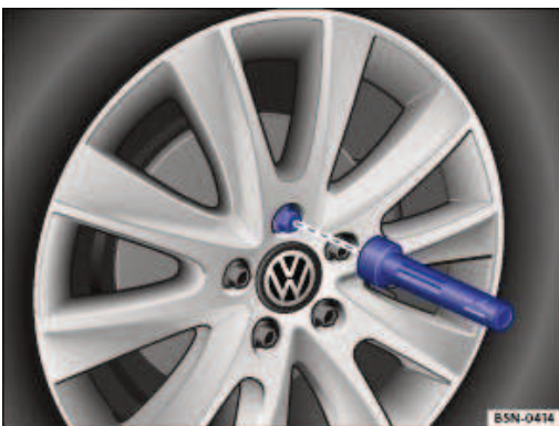
Fig. 230 Changement d'une roue : dévissage des boulons de roue à l'aide du manche de tournevis
