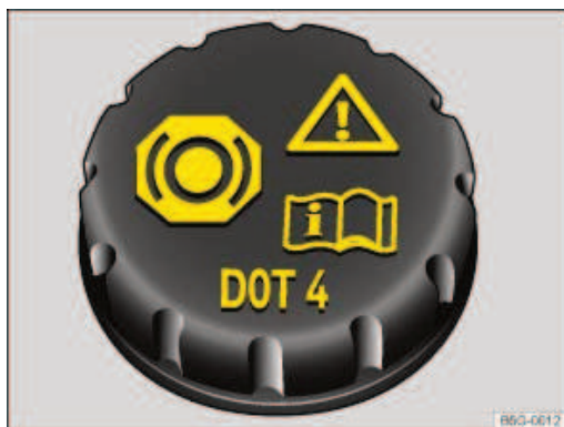
Fig. 211 Dans le compartiment-moteur : bouchon du réservoir de liquide de frein
