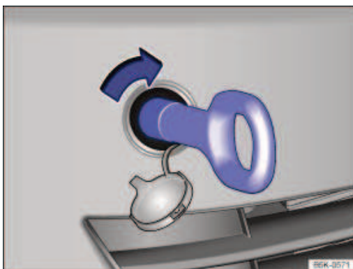
Fig. 202 Dans le pare-chocs avant, côté droit : vissage de l'œillet de remorquage
