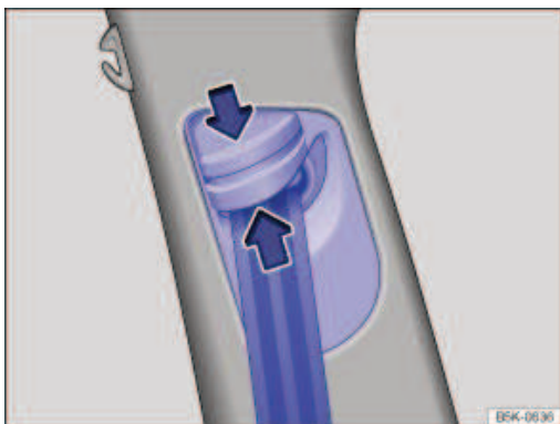
Fig. 40 À côté des sièges avant : réglage en hauteur de la ceinture
