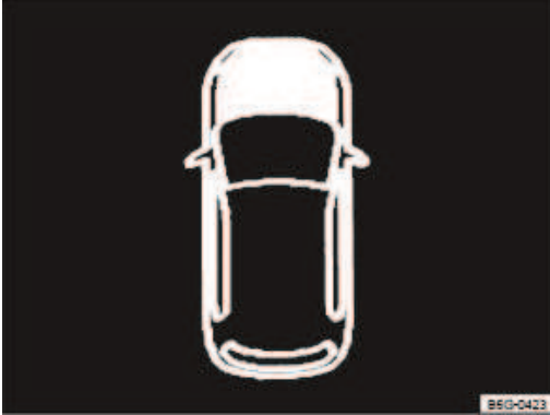
Fig. 205 Afficheur du combiné d'instruments : capot-moteur ouvert ou mal fermé (schéma de principe)
