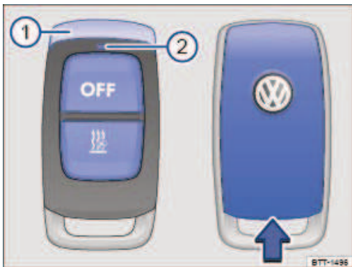
Fig. 104 Chauffage stationnaire : radiocommande (à gauche) avec compartiment à pile (à droite)
