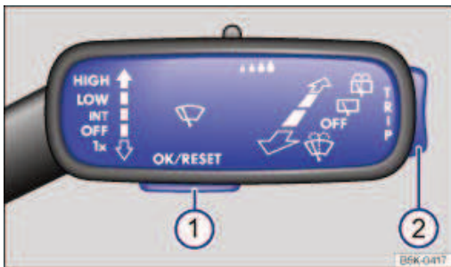
Fig. 22 À droite sur la colonne de direction : touches sur le levier d'essuie-glace (schéma de principe)
