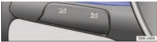
Fig. 124 Côté gauche du volant multifonction : touches de commande du régulateur de vitesse
