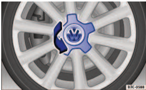
Fig. 221 Retrait de l'enjoliveur central par un mouvement de rotation
