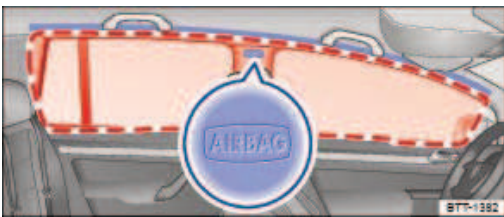
Fig. 47 Côté gauche du véhicule : emplacement de montage et zone de déploiement du sac gonflable de tête
