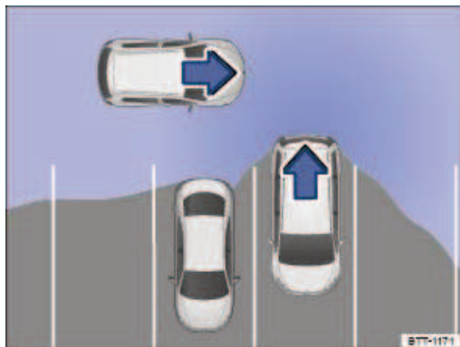
Fig. 143 Schéma de principe de l'assistant de sortie de stationnement : zone surveillée autour du véhicule sortant de la place de stationnement
