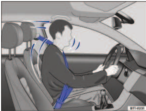
Fig. 35 Conducteur correctement attaché, retenu par sa ceinture de sécurité lors d'un freinage brusque
