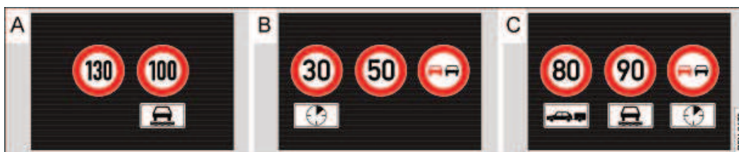
Fig. 15 Sur l'afficheur du combiné d'instruments : exemples de panneaux de limitation de vitesse et d'interdiction de dépasser détectés avec les panneaux supplémentaires correspondants
