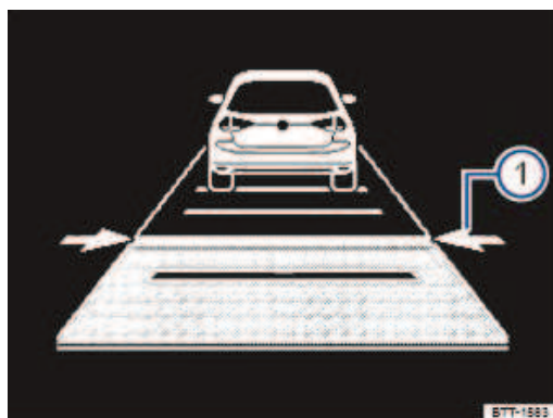
Fig. 131 Sur l'afficheur du combiné d'instruments : réglage de la distance (schéma de principe, régulateur de distance actif)
