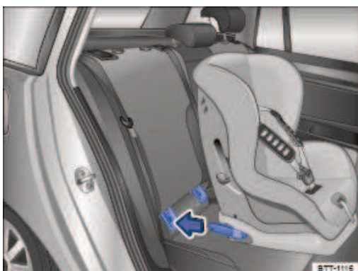
Fig. 54 Schéma de principe : installation d'un siège pour enfants ISOFIX avec verrous
