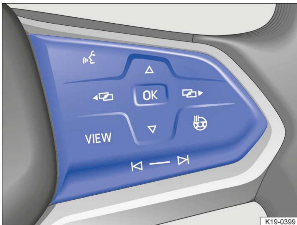
Fig. 2 Côté droit du volant multifonction : touches de commande des menus et des informations dans le combiné d'instruments (variante 2)
