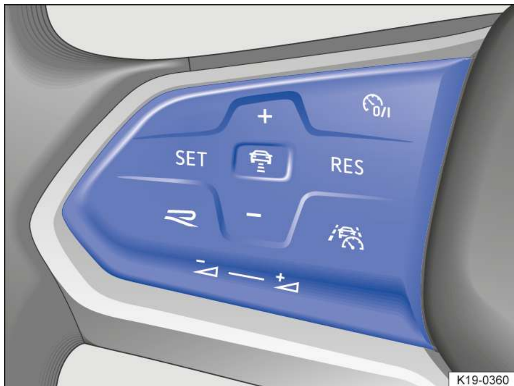
Fig. 2 Côté gauche du volant multifonction : touches de commande du limiteur de vitesse (variante 2)
