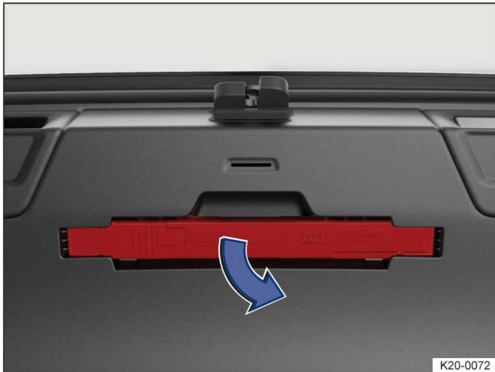
Fig. 1 Dans le capot arrière : support du triangle de présignalisation.
