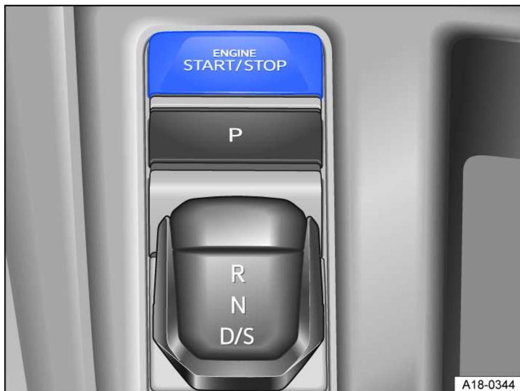
Fig. 2 Dans la partie inférieure de la console centrale : bouton de démarrage du moteur (véhicules avec boîte DSG à double embrayage)
