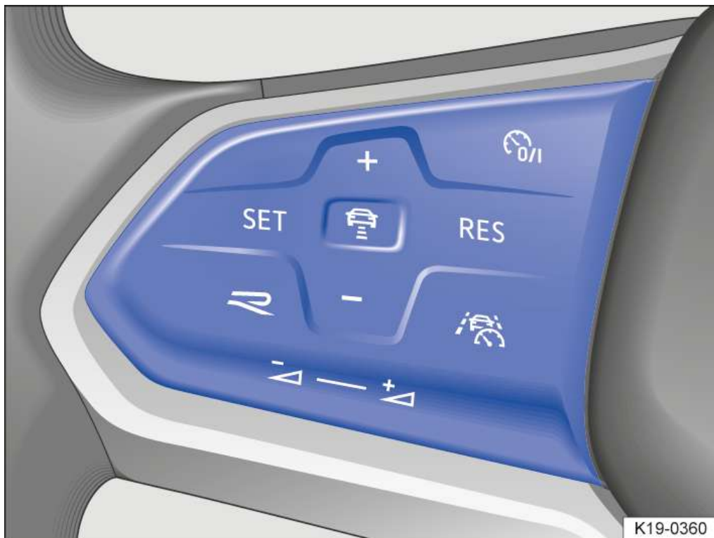
Fig. 2 Côté gauche du volant multifonction : touches de commande du régulateur de vitesse (variante 2)
