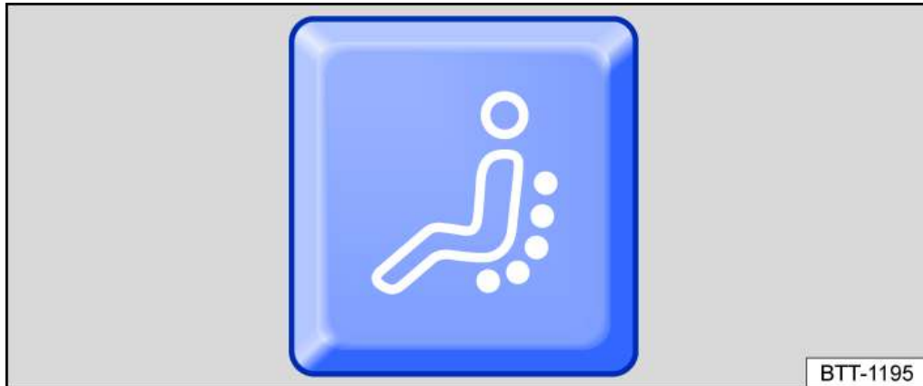
Fig. 1 Dans la zone inférieure du siège du conducteur : touche de la fonction de massage
