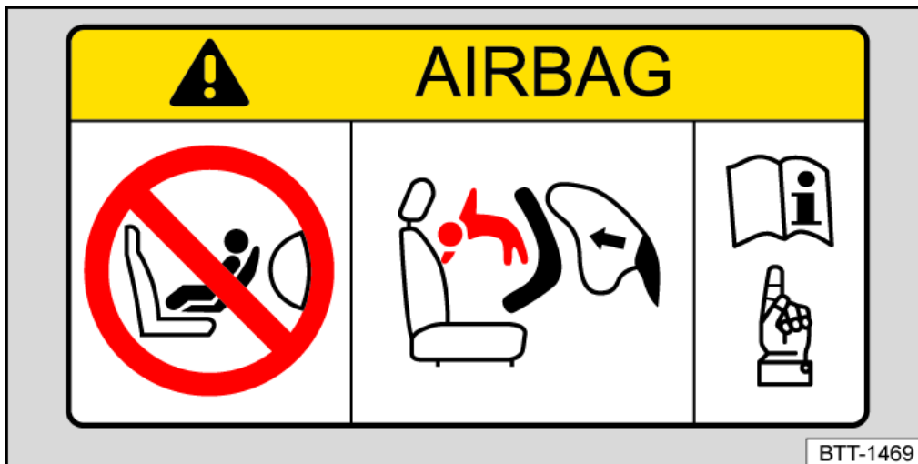
Fig. 1 Schéma de principe : étiquette de sac gonflable sur le pare-soleil
