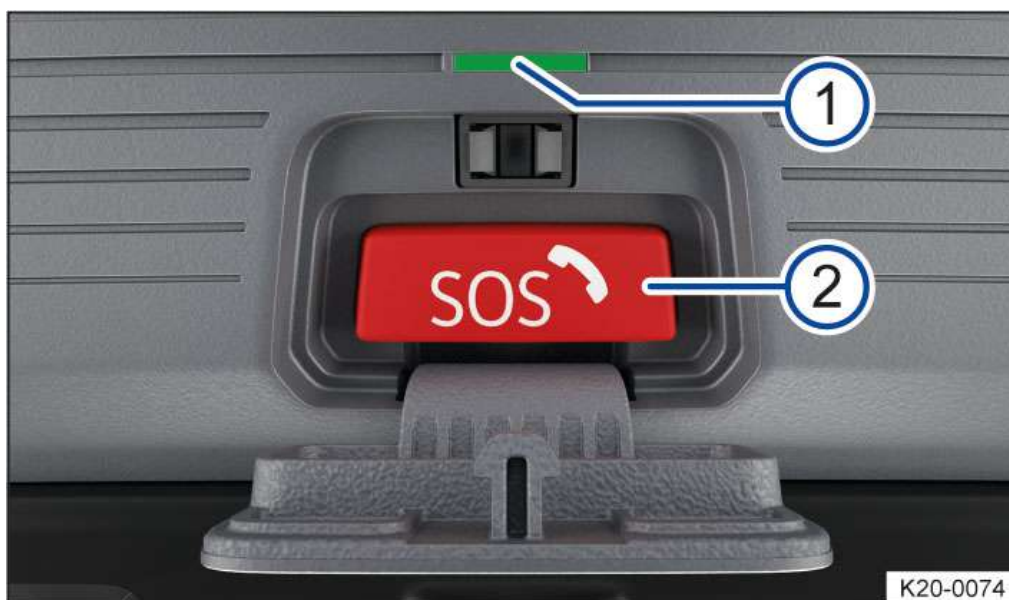
Fig. 2 Élément de commande pour l'appel d'urgence : témoin de contrôle et touche
