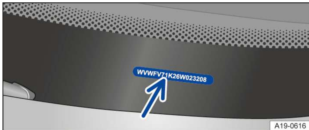
Fig. 1 Sur le pare-brise : numéro d'identification du véhicule
