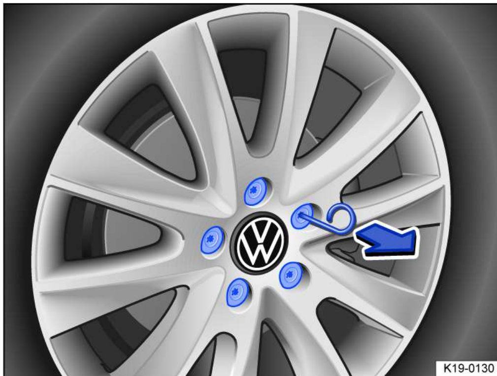
Fig. 1 Retrait des capuchons de boulons de roue
