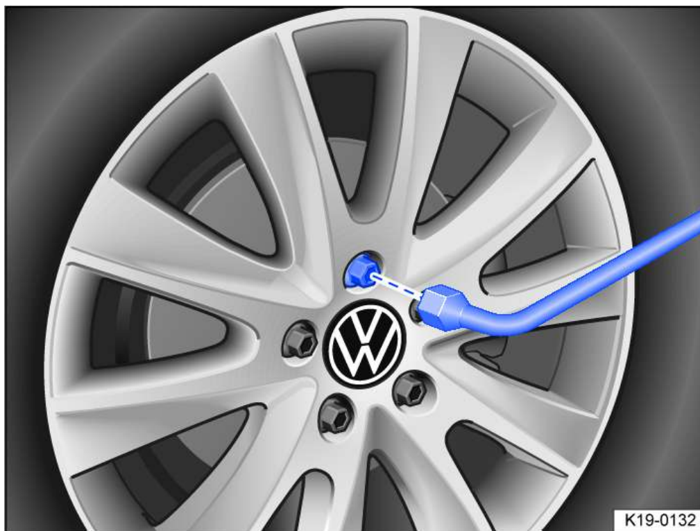
Fig. 1 Changement de roue : dévissage des boulons de roue avec la clé de roue
