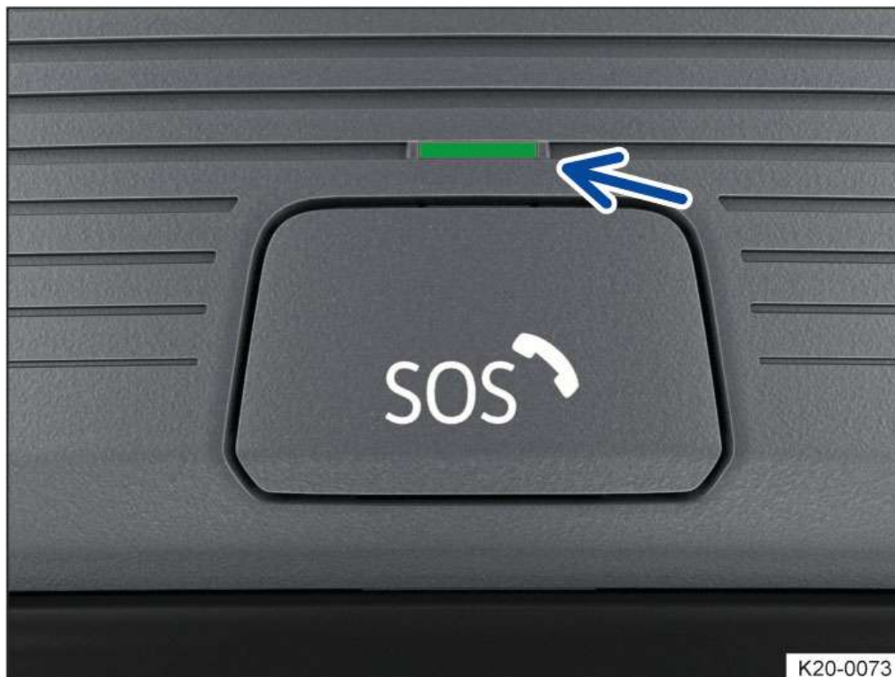
Fig. 1 Dans la console de pavillon : éléments de commande pour le système d'appel d'urgence légal eCall (derrière le couvre-touche)
