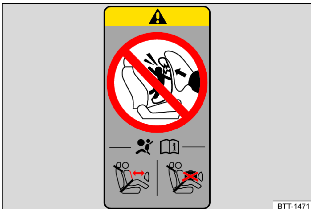
Fig. 2 Schéma de principe : étiquette de sac gonflable sur le montant B
