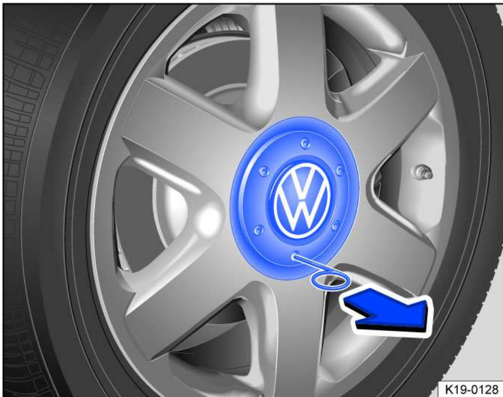
Fig. 1 Retrait de l'enjoliveur central par extraction
