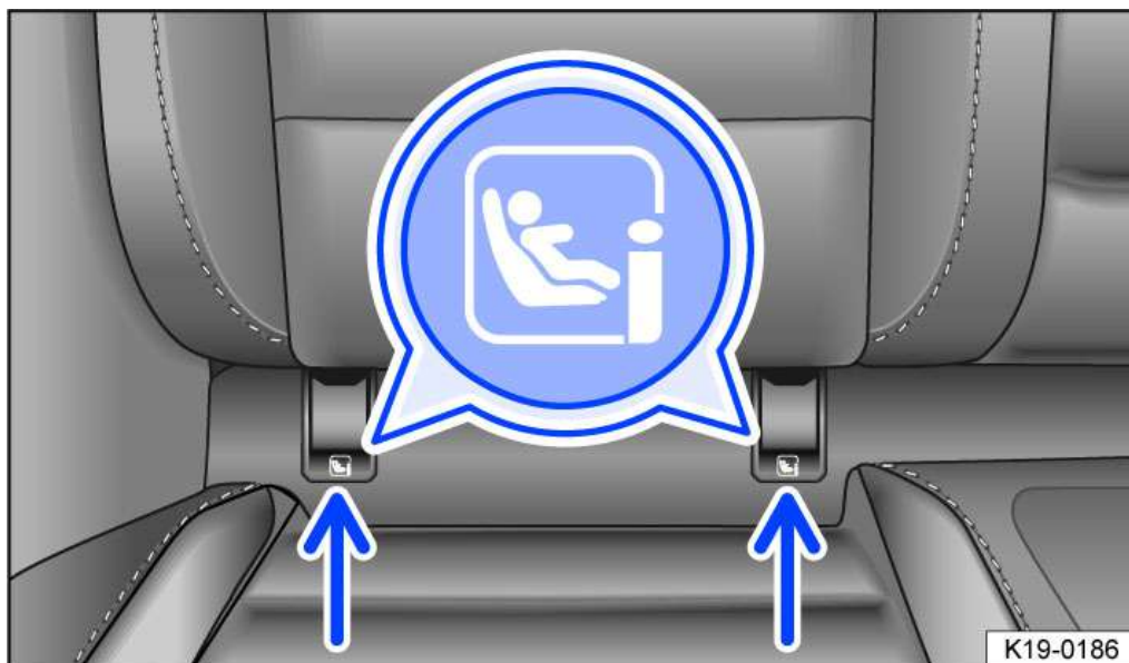
Fig. 2 Repérage des points d'ancrage i-Size pour sièges pour enfants aux places de la banquette arrière
