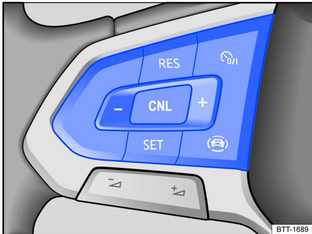
Fig. 1 Côté gauche du volant multifonction : touches de commande du limiteur de vitesse (variante 1)
