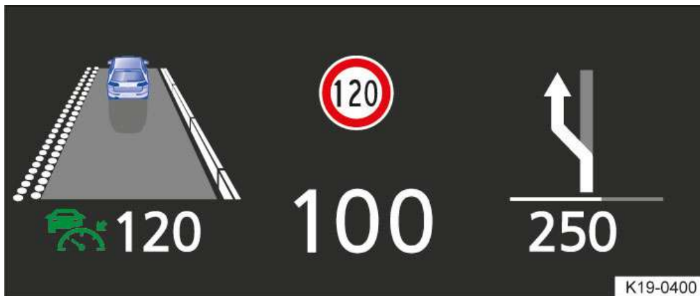
Fig. 1 Dans le champ de vision du conducteur : exemples d'affichage tête haute
