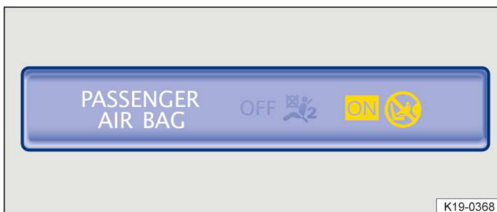
Fig. 2 Dans la console de pavillon : témoin de contrôle (schéma de principe) pour l'activation du sac gonflable du passager avant
