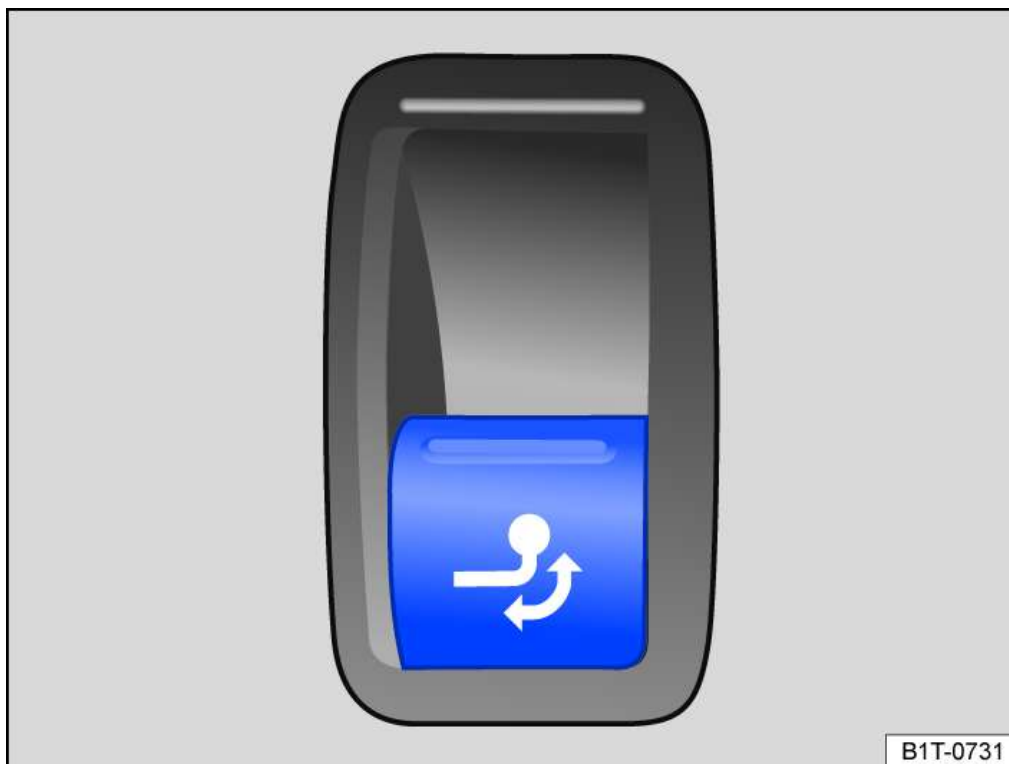
Fig. 1 À droite dans le coffre à bagages : touche de déverrouillage de la boule d'attelage
