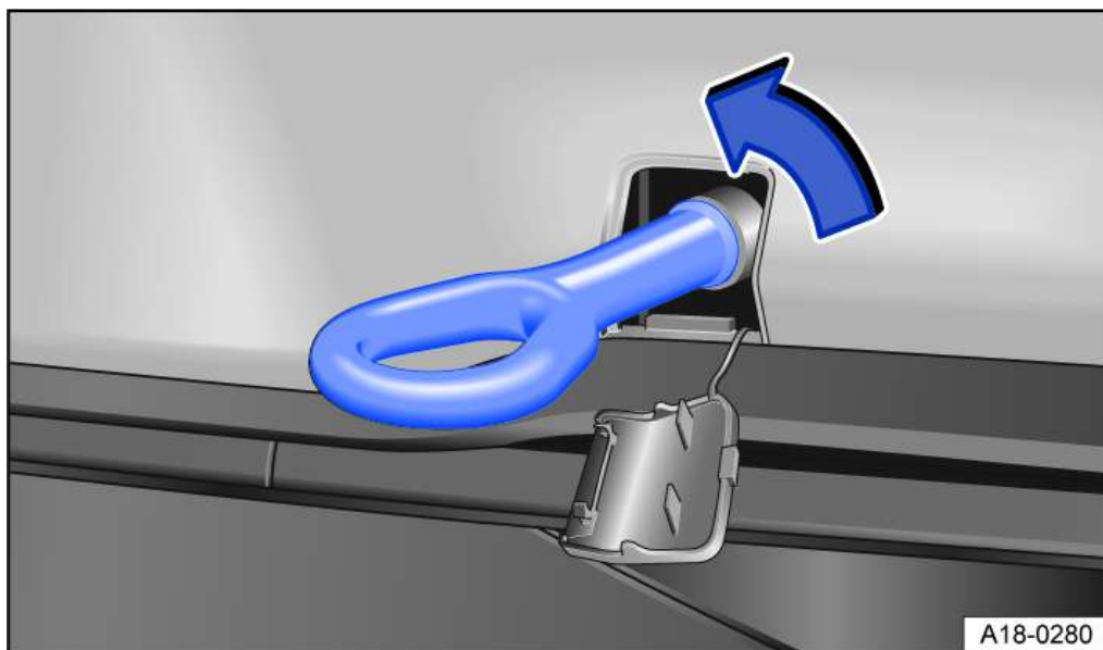
Fig. 2 Dans le pare-chocs arrière, côté droit : vissage de l'œillet de remorquage
