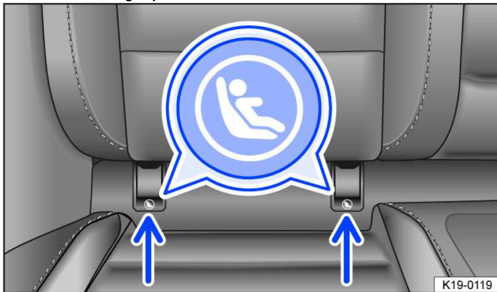
Fig. 1 Repérage des points d'ancrage ISOFIX pour sièges pour enfants aux places de la banquette arrière
