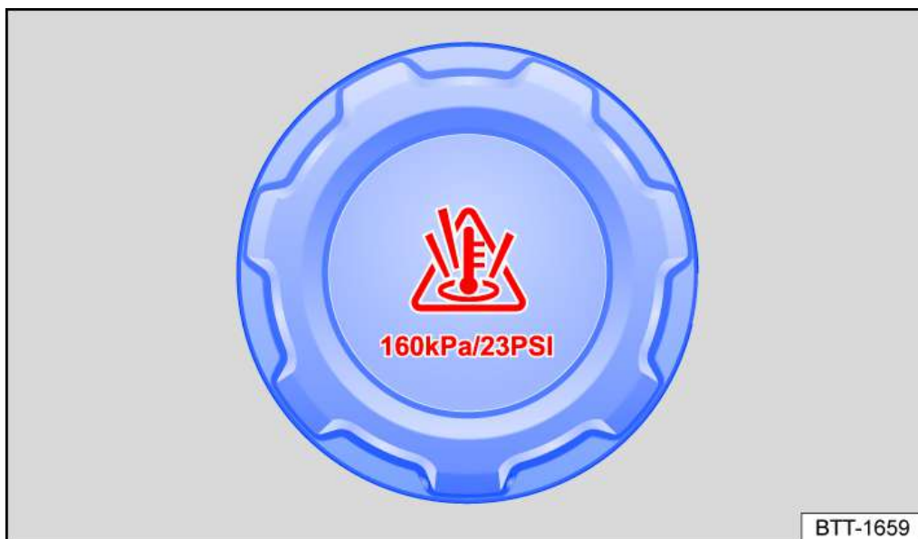
Fig. 2 Dans le compartiment-moteur : bouchon du vase d'expansion du liquide de refroidissement (schéma de principe)
