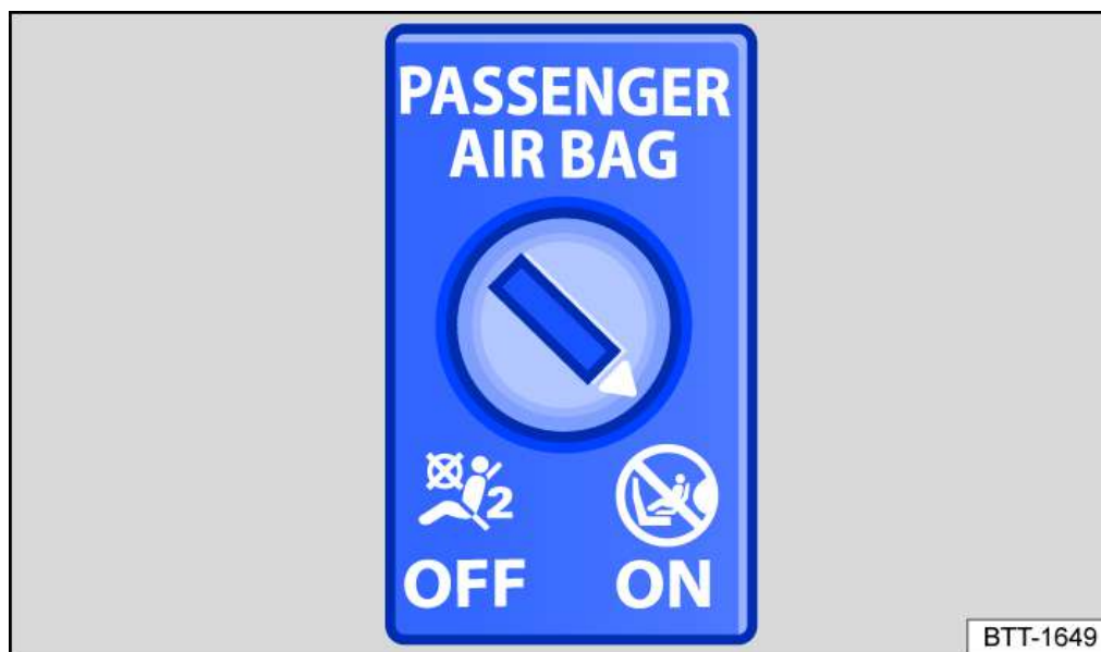
Fig. 1 Dans le tableau de bord côté passager avant : commande à clé pour la désactivation et l'activation du sac gonflable du passager avant
