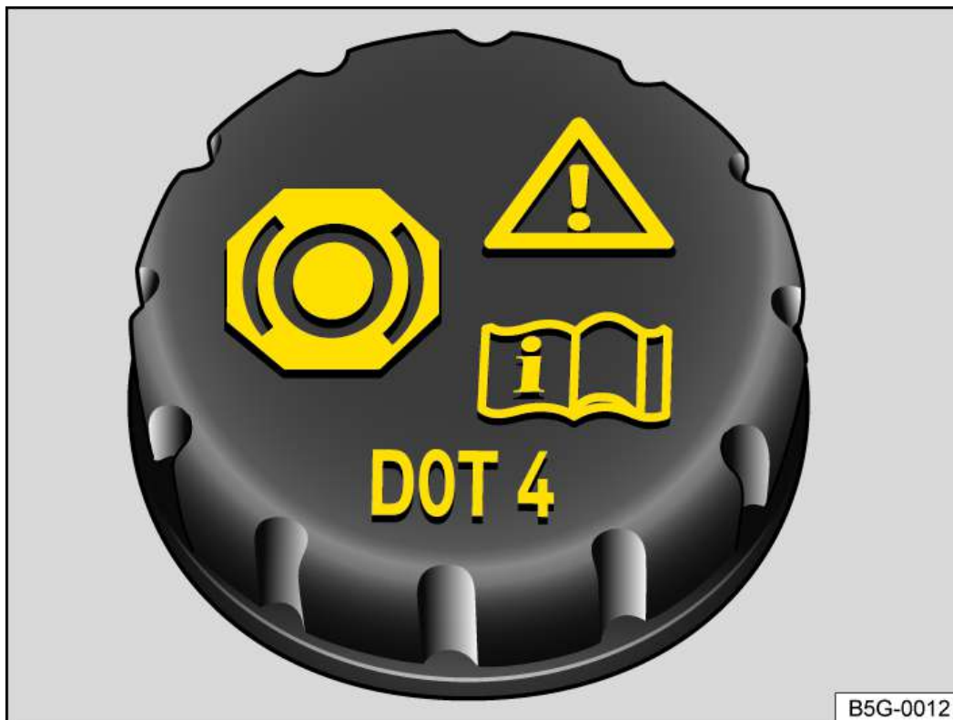
Fig. 1 Dans le compartiment-moteur : bouchon du réservoir de liquide de frein
