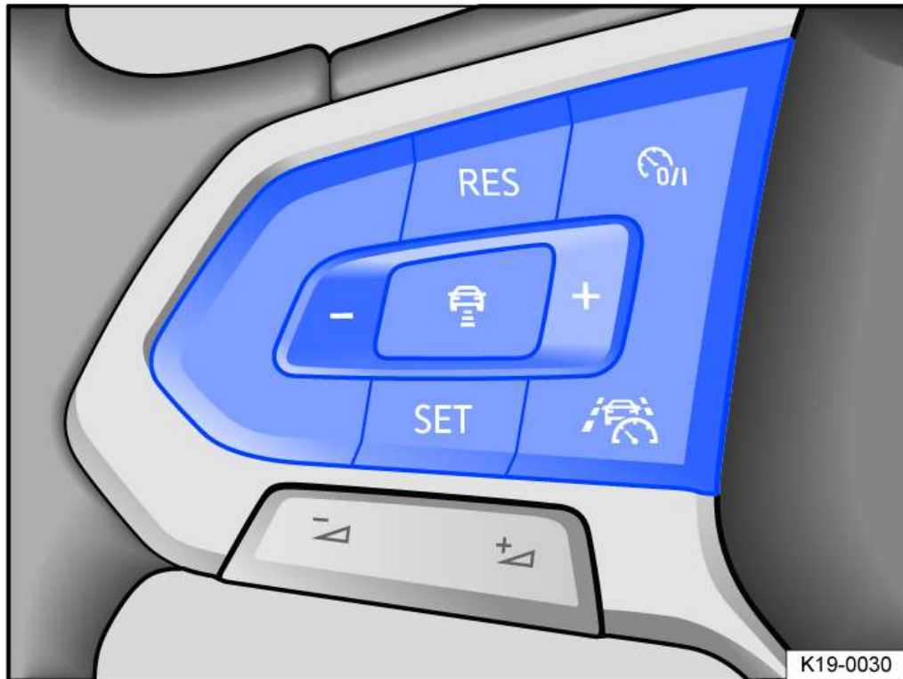
Fig. 1 Côté gauche du volant multifonction : touches de commande de l'assistant de conduite (Travel Assist) (variante 1)
