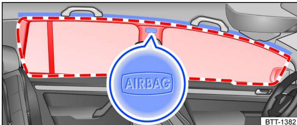
Fig. 1 Côté gauche du véhicule : emplacement de montage et zone de déploiement du sac gonflable de tête
