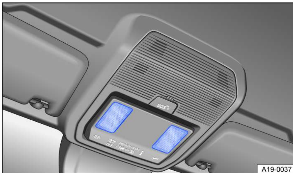
Fig. 1 Dans la console de pavillon : lampes de lecture tactiles
