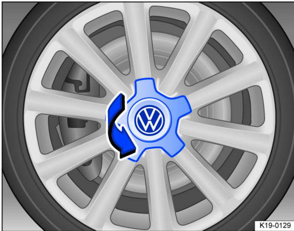
Fig. 2 Retrait de l'enjoliveur central par rotation
