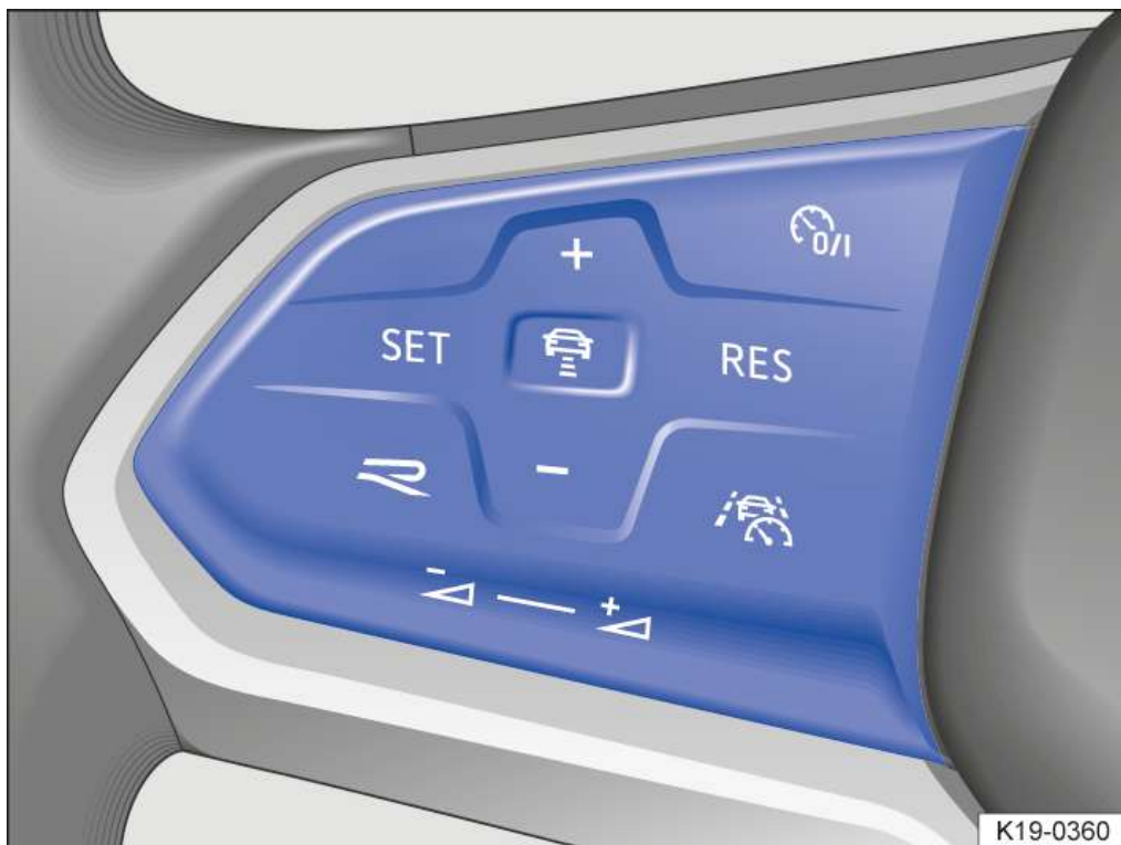
Fig. 2 Côté gauche du volant multifonction : touches de commande de l'assistant de conduite (Travel Assist) (variante 2)
