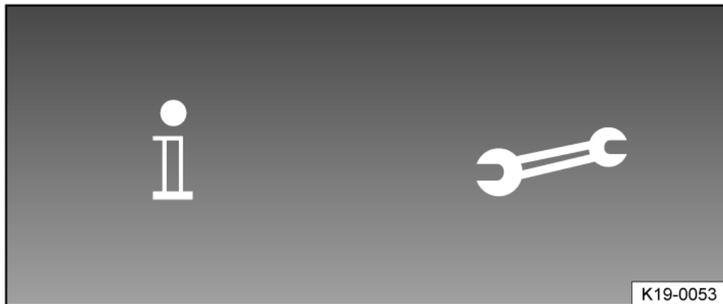
Fig. 1 Dans la console de pavillon : élément de commande pour appel informatif et appel de dépannage
