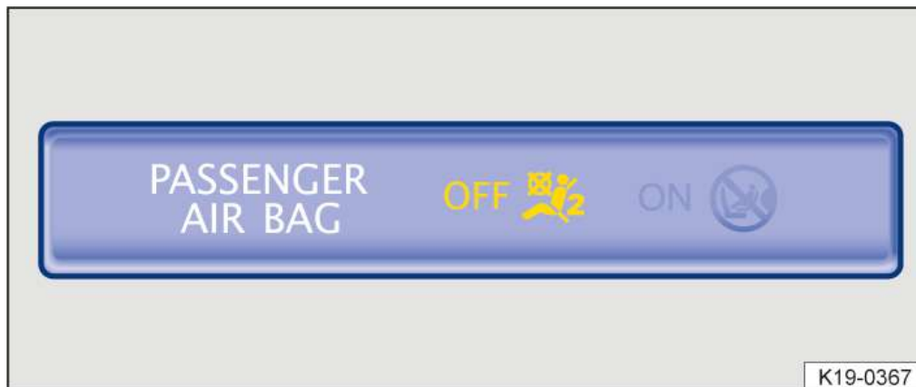
Fig. 1 Dans la console de pavillon : témoin de contrôle (schéma de principe) pour la désactivation du sac gonflable du passager avant
