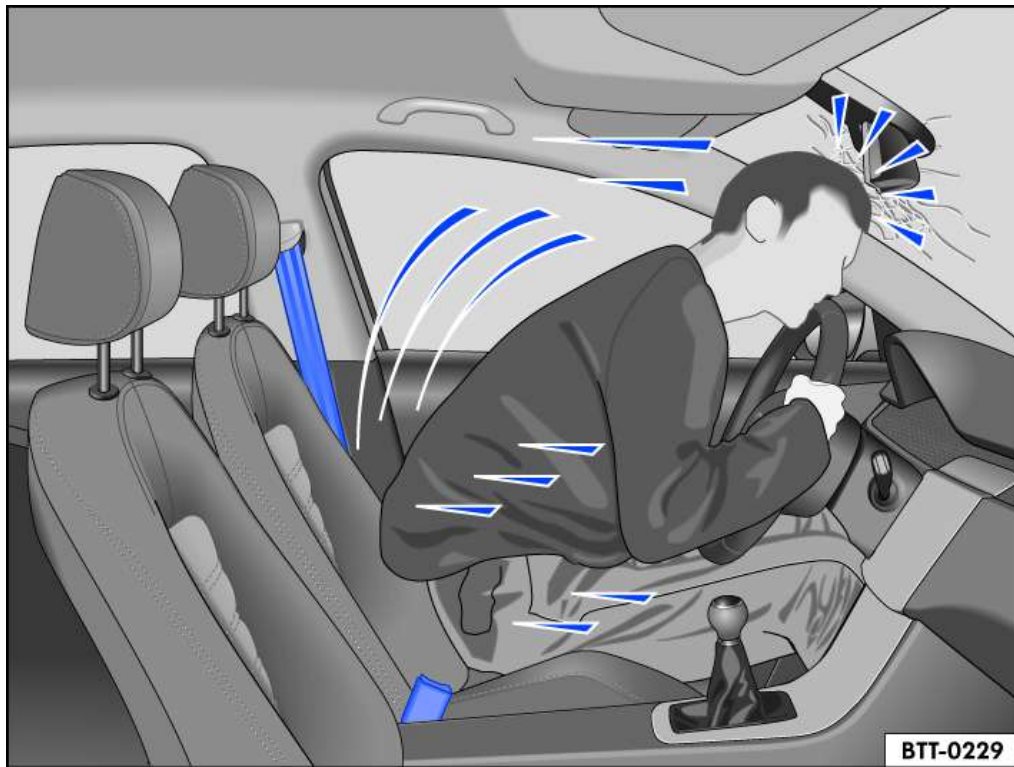
Fig. 1 Conducteur non attaché projeté en avant
