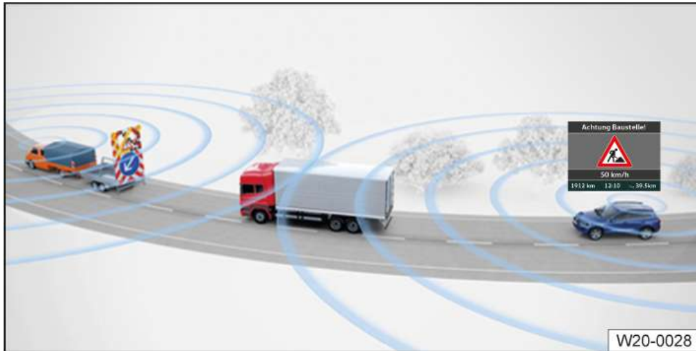
Fig. 1 Schéma de principe : avertissement de danger de chantiers temporaires et mobiles
