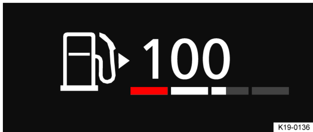
Fig. 2 Indicateur de niveau de carburant dans le combiné d'instruments numérique
