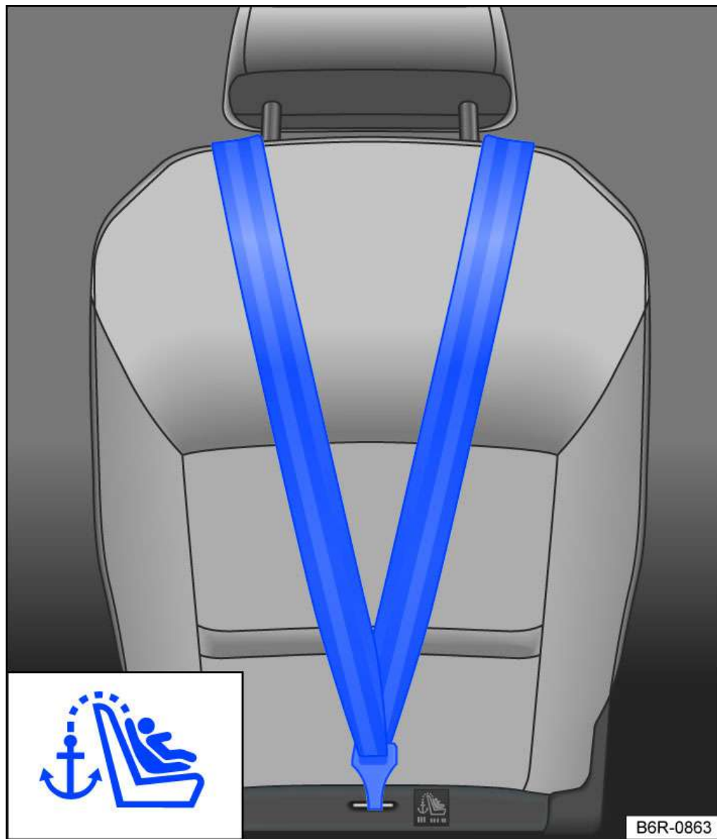
Fig. 2 Au dos du siège du passager avant : ceinture de retenue supérieure accrochée
