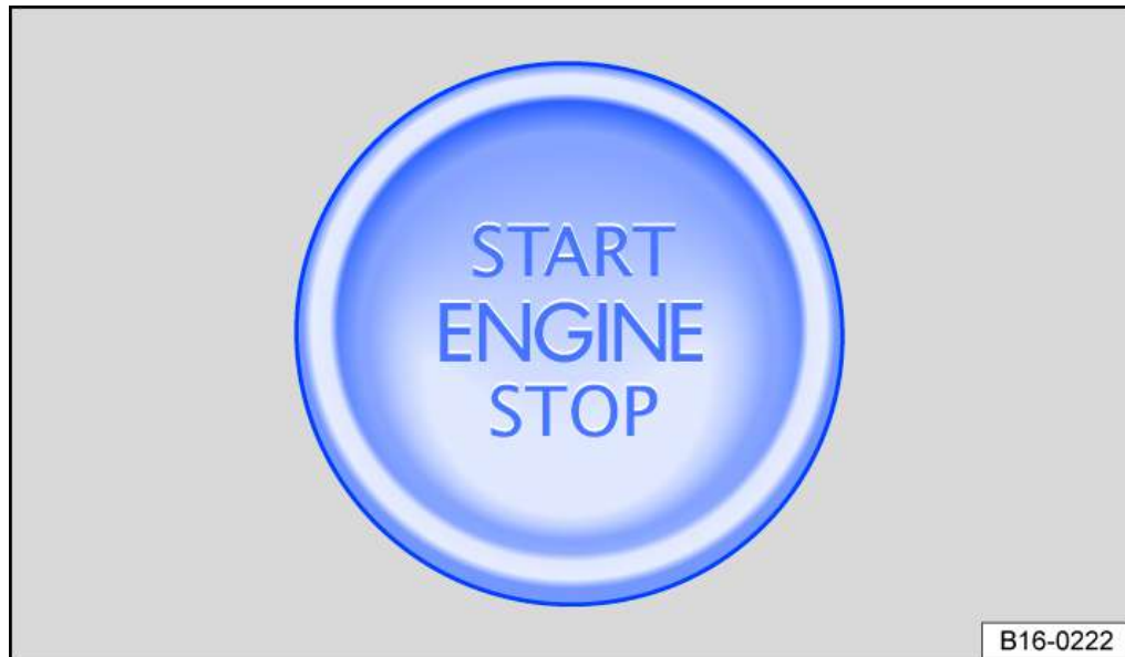
Fig. 1 Dans la partie inférieure de la console centrale : bouton de démarrage du moteur (véhicules avec boîte mécanique)
