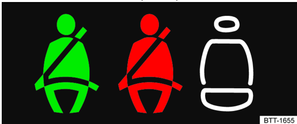
Fig. 2 Sur l'afficheur du combiné d'instruments : indicateur de statut des ceintures pour les places arrière
