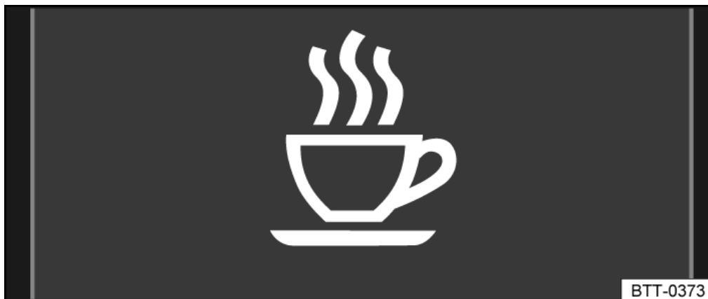
Fig. 1 Sur l'afficheur du combiné d'instruments : symbole du détecteur de fatigue
