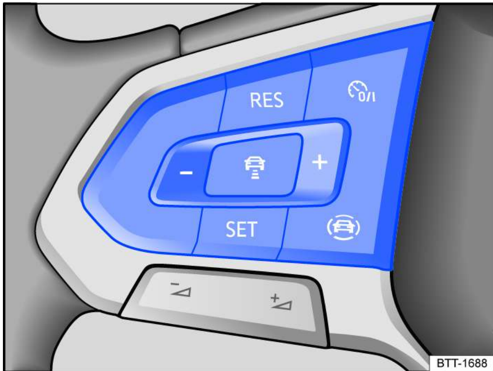
Fig. 1 Côté gauche du volant multifonction : touches de commande du régulateur de distance (variante 1)
