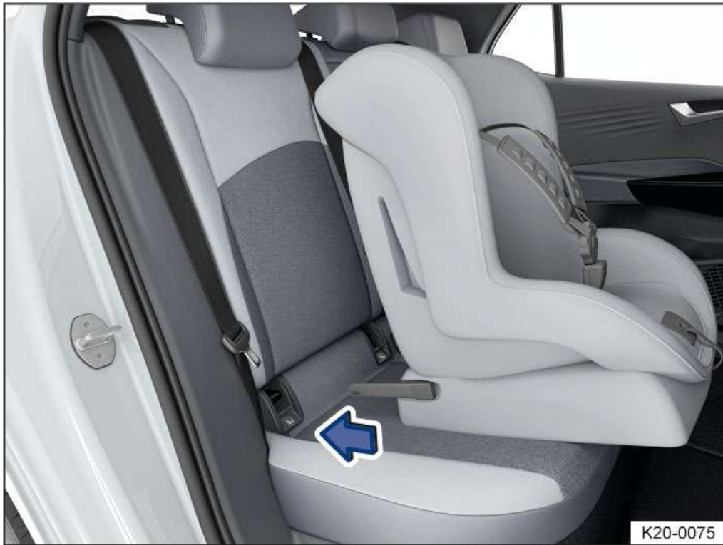
Fig. 4 Schéma de principe : installation d'un siège pour enfants avec verrous
