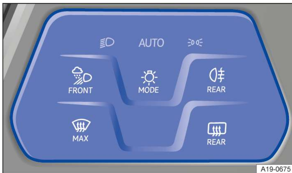
Fig. 1 Près du volant : panneau tactile pour allumer l'éclairage extérieur
